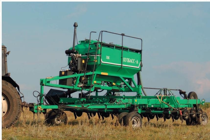
Малогабаритный посевной комплекс «Кузбасс-А» ПК-5,5Б представляет собой сельхозмашину, использующую технологию посева по принципу «в открытую борозду», когда семена высеваются в более глубокие и влажные слои почвы, а затем покрываются слоем почвы и прикатываются.
