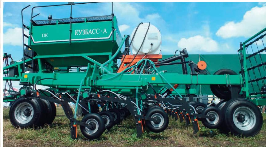
Посевной комплекс «Кузбасс-А» спроектирован таким образом, что часть веса бункера перераспределяется на заднюю ось трактора. В результате увеличивается сцепной вес трактора, снижается буксование, увеличивается маневренность агрегата, плавность хода машины в целом.
