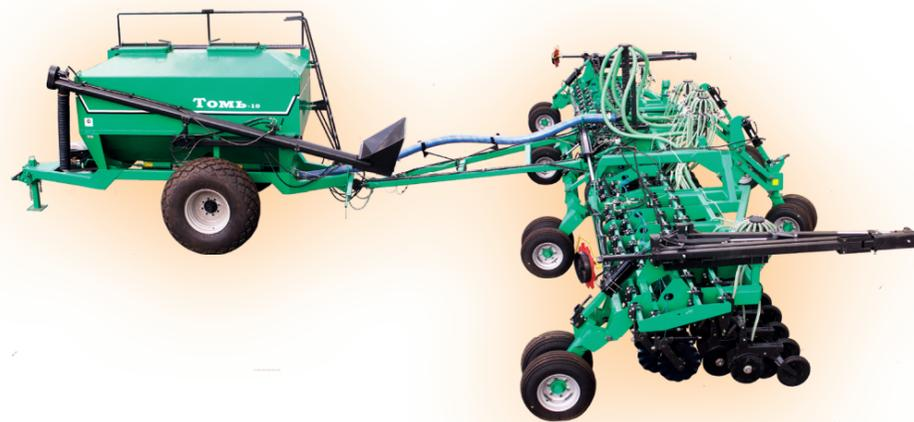
Посевной комплекс «Томь» идеален для работы в севооборотах с активным использованием почвопокровных и сидеральных культур, поскольку минимально нарушает защитный мульчирующий слой на поверхности почвы и позволяет сохранить ее естественную структуру. Комплекс обеспечивает точное дозирование семян и удобрений и размещение их в почве за счет качественного копирования поверхности поля.
