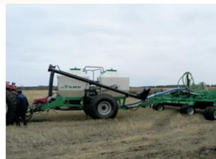
Дозирующие механизмы катушечного типа, установленные на бункере, обеспечивают равномерный и качественный высеv зерновых, зернобобовых и технических культур, в том числе мелкозерновых. Необходимый расход материала легко устанавливается с помощью регулирующей заслонки дозатора. Привод дозаторов осуществляется от колеса бункера через электромагнитную муфту, либо от опорного колеса орудия на ПК-5,1Б и 6,3Б.
