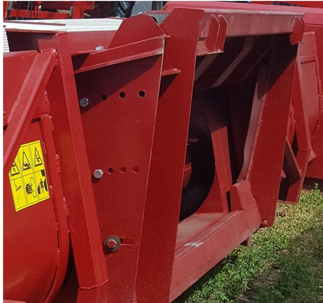
**Рамка имеет регулировки наклона для уборки разной высоты подсолнечника**
