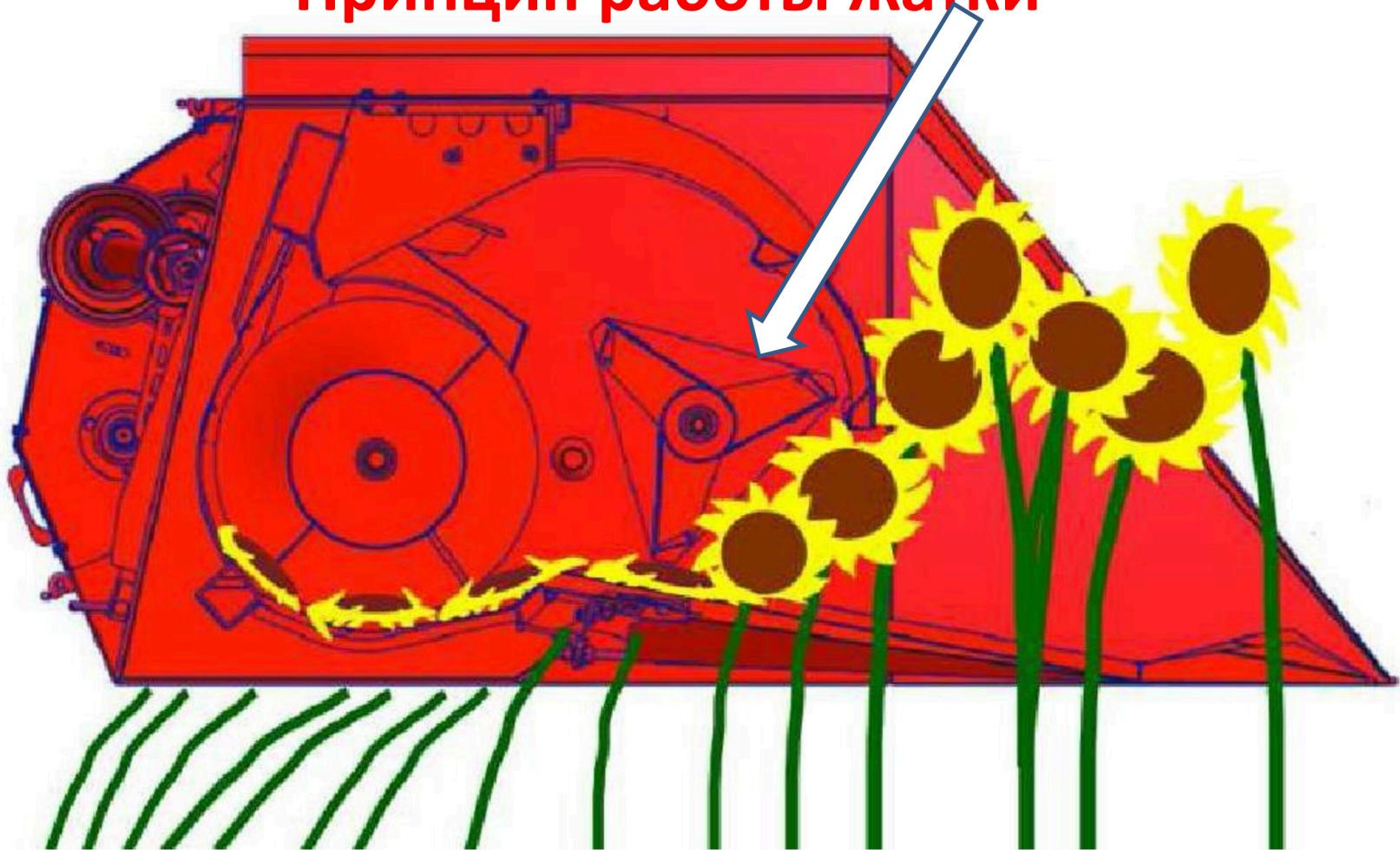
Продвигаясь по посевам подсолнечника **лифтеры направляют подсолнечник к мотовилу** и оно подает подсолнечник к режущему аппарату, тем самым срезаются только шляпки, подаются к шнеку и в наклонную камеру комбайна
